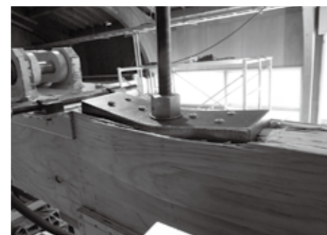
図 2-9 耐圧プレートのめり込み
